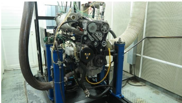
شکل ۱: موتور گازسوز EF7 نصب شده در اتاق تست شرکت دیناموتور
